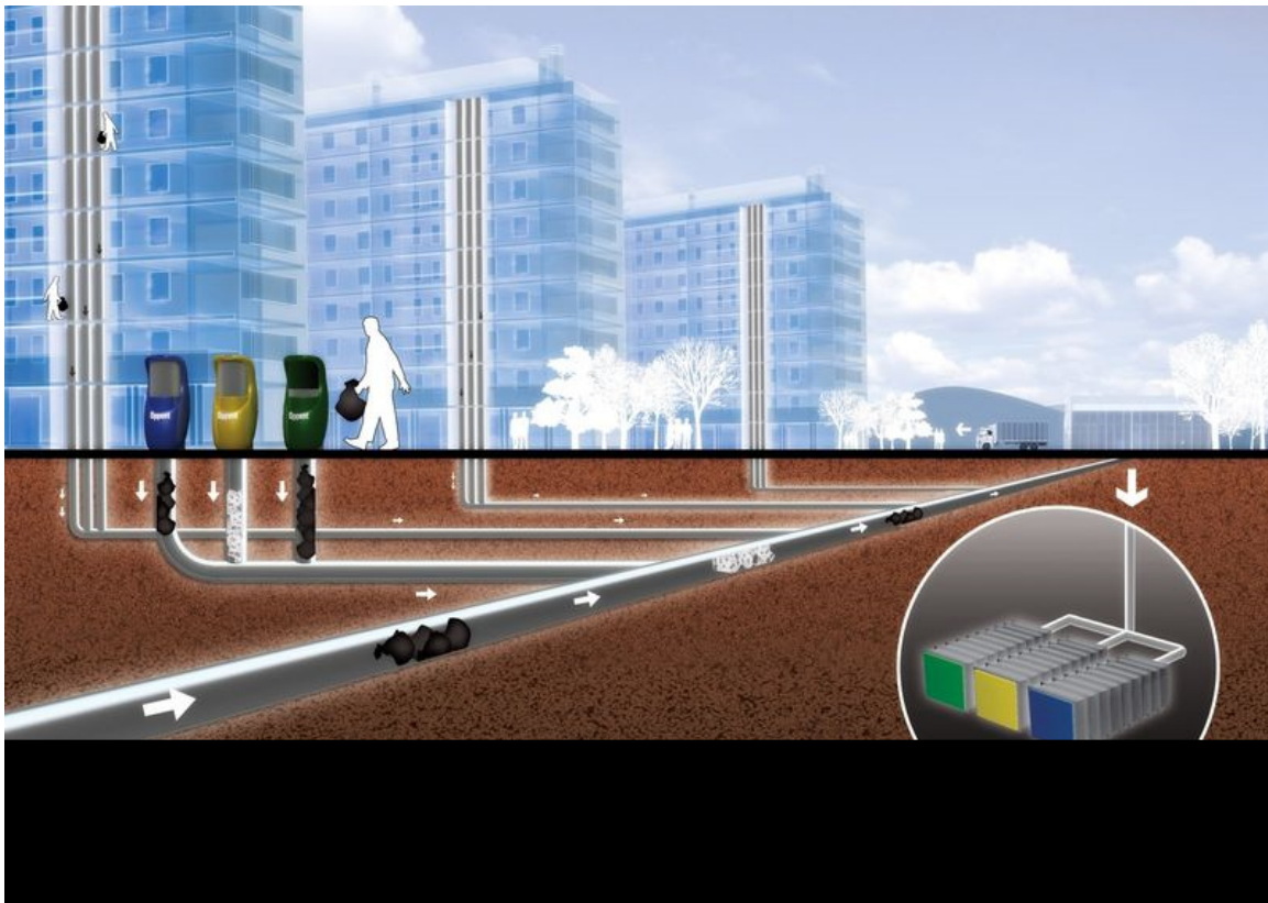
L'immagine illustra come funzionerebbe il sistema Oppent per la raccolta pneumatica dei rifiuti
